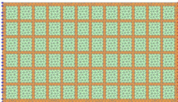
La mesh dell'elemento, rappresentata qui a fianco, ricalca esattamente la geometria della sezione del blocco.
