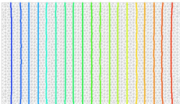
La disposizione delle linee isoterme consente di valutare qualitativamente l'andamento del flusso termico passante attraverso la sezione analizzata. Tanto più le isoterme sono "parallele" e rettilinee tanto più il flusso termico tende ad essere sostanzialmente uniforme nei diversi punti della sezione dell'elemento.
